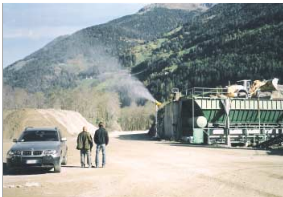
La proiezione di acqua nebulizzata consente di portare a terra le polveri realizzando nel contempo uno strato umido, senza la creazione di ruscellamenti, che impedisce a queste ultime di risollevarsi durante il passaggio dei mezzi
