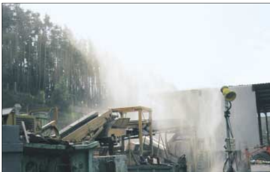
Per conseguire un efficace abbattimento al suolo delle polveri la WLP ha sviluppato uno speciale cannone a nebbia capace di nebulizzare l'acqua e proiettarla a notevoli distanze dal punto di emissione
